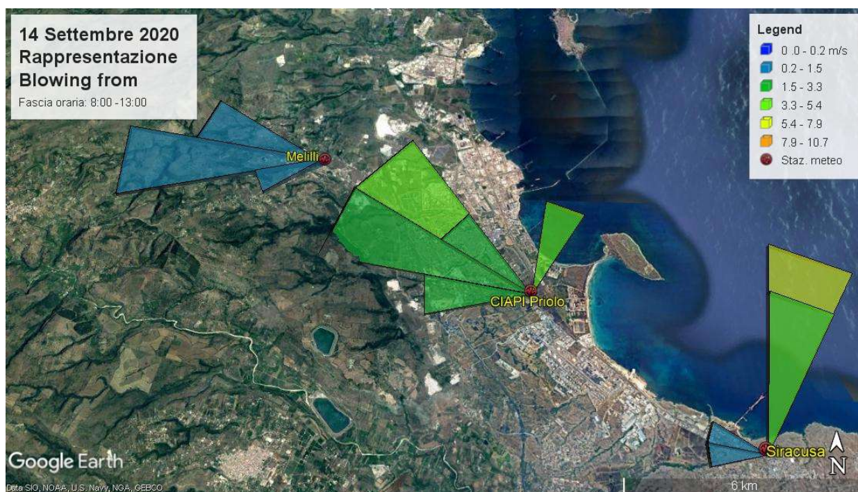
Figura 2: Andamento della direzione ed intensità dei venti registrati dalle stazioni meteorologiche dell'AERCA Siracusa il 14 settembre (dalle 08:00 alle 13:00)
