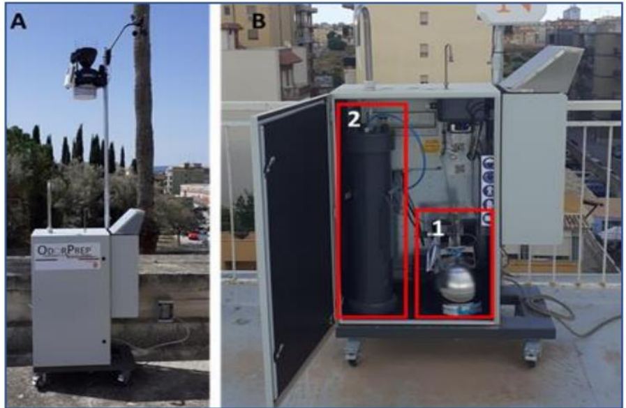
Centralina di campionamento – Chiusa (A); Aperta (B): 1. Canister; 2. sacca in nalophan™
