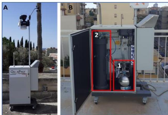
Centralina di campionamento – Chiusa (A); Aperta (B): 1. Canister; 2. sacca in nalophan™
