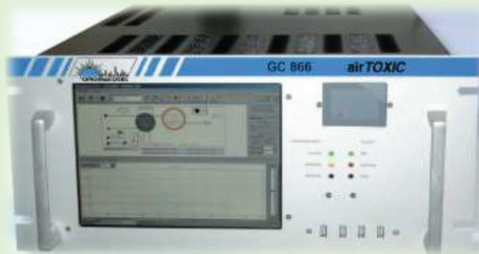
Il campione, portato a pressione atmosferica e temperatura costante, viene iniettato automaticamente in colonna, dove il metano viene separato dagli altri analiti e viene inviato al rilevatore a ionizzazione di fiamma (FID), che genera un unico segnale elettrico, corrispondente alla misura della concentrazione del metano.
