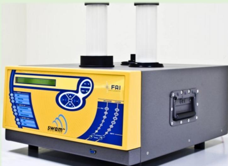
L'accumolo del materiale particolato sospeso avviene per il tempo definito ed in continuo, su una coppia di filtri - ciascuno corrispondente ad una distinta linea di prelievo - e la determinazione della massa del particolato raccolto è eseguita immediatamente dopo il periodo di campionamento.
