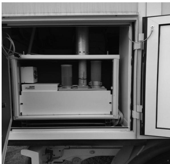
La foto sopra mostra il Polverimetro presente all'interno del Laboratorio Mobile per la determinazione delle Polveri PM<sub>10</sub>. Il laboratorio mobile ha in dotazione anche due strumenti di nuova generazione per la ricerca in aria ambiente di sostanze organiche volatili e di sostanze solforate, di seguito descritti:
