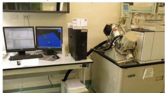
Nella foto sopra e in quella a fianco, sono ripresi 2 Gas cromatografi con rivelatore di massa (GC-MS), rispettivamente con sistema di estrazione e concentrazione purges and trap il primo e con selettore di massa a tempo di volo (TOF) il secondo, entrambi in dotazione alla struttura territoriale di Ragusa che cura la determinazione di una serie di microinquinanti per ARPA Sicilia.
