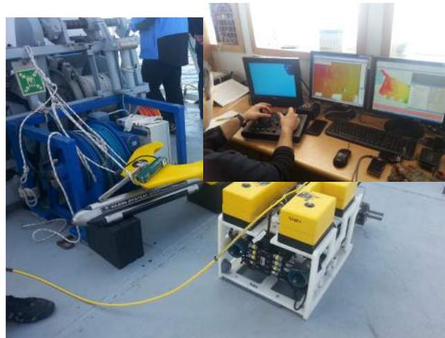
Nel corso delle diverse campagne attivate a seguito delle differenti convenzioni nelle quali è coinvolta ARPA Sicilia, sono stati acquisiti i dati morfobatimetrici attraverso rilievi con metodi ecografici e raccolta di dati immagine georeferenziati ad alta risoluzione (foto/video) mediante veicoli operati da remoto (ROV) per valutare la presenza e l'estensione e le condizioni dell'habitat a coralligeno.
