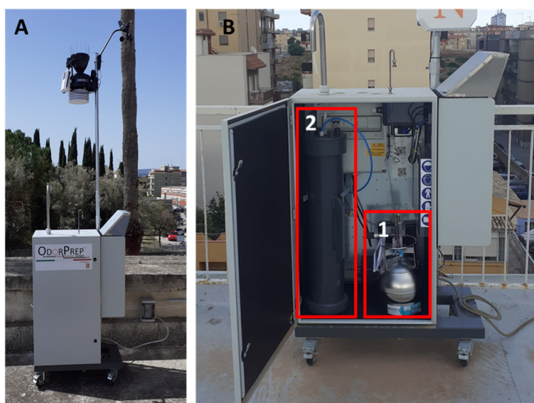
Figura 2. Centralina di campionamento – Chiusa (A); Aperta (B): 1. Canister; 2. Tubo con sacca in nalophan™
