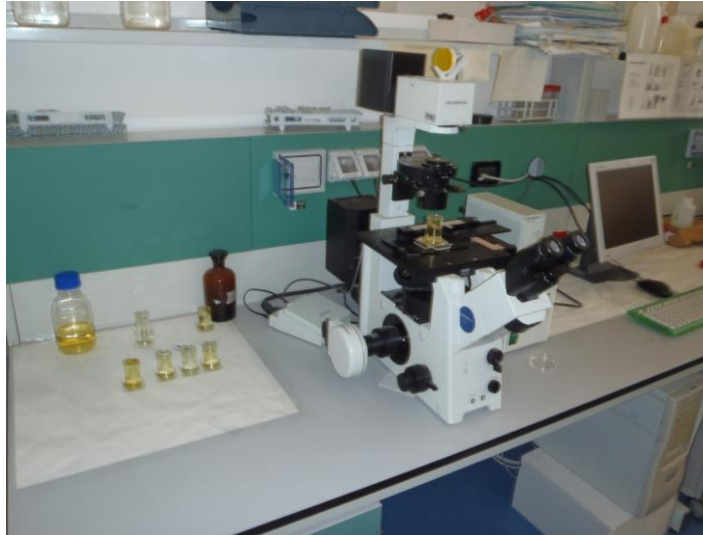
Foto 3: Microscopio ottico invertito e camere di sedimentazione
