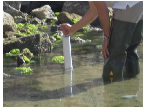
Foto 2: Misura dei parametri chimico-fisici con sonda multiparametrica
