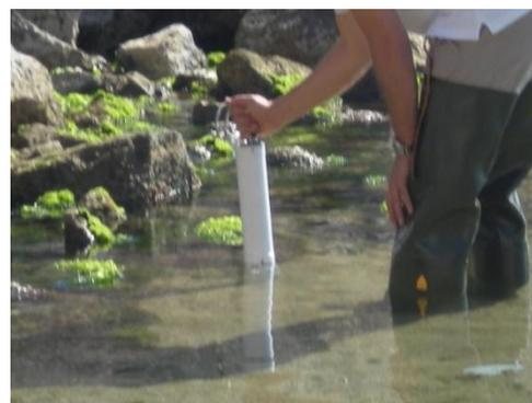
Foto 2: Misura dei parametri chimico-fisici con sonda multiparametrica
