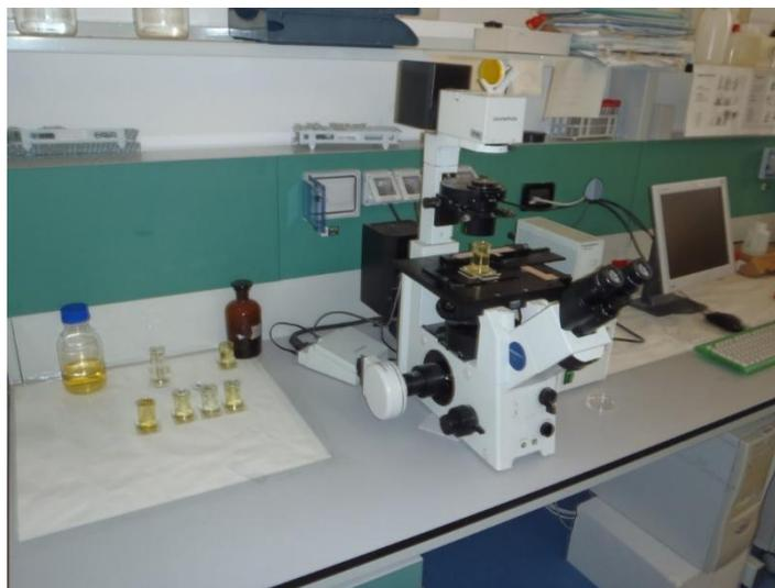
Foto 3: Microscopio ottico invertito e camere di sedimentazione
