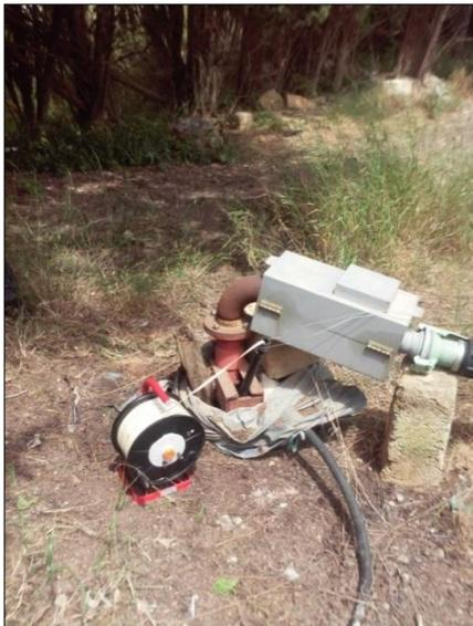
*Figura 6.3 -Pozzo in esercizio continuo con tubo piezometrico in PE*
