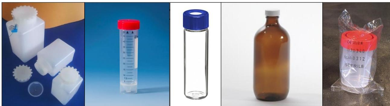
*Figura 7.4 - Esempio di contenitori (non in scala) per le varie aliquote previste; da sinistra verso destra: polietilene (PE o HDPE) con tappo e sottotappo, polipropilene tipo Falcon (PP), Vials in vetro con tappo munito di setto forabile, bottiglia di vetro scuro ambrato con tappo in PTFE, polipropilene sterile.*
