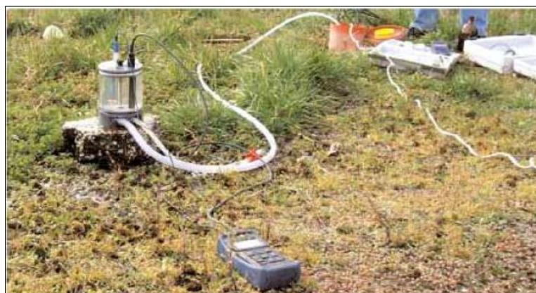
Figura 7.2- Sistema di campo per la misurazione dei parametri chimico-fisici delle acque di spurgo, con cella di flusso (Fonte: APAT, Manuale 43/2006)
