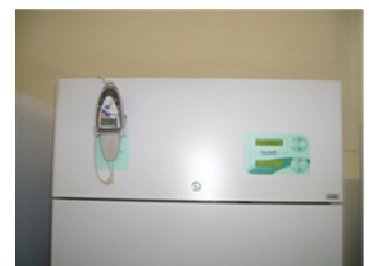
Monitoraggio apparecchiature termostatiche
