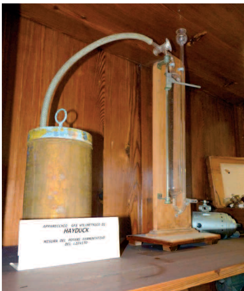
Apparecchio di Hayduck per la determinazione del potere lievitante (1968)
