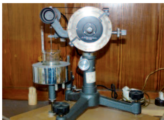
Apparato per la determinazione della tensione superficiale
